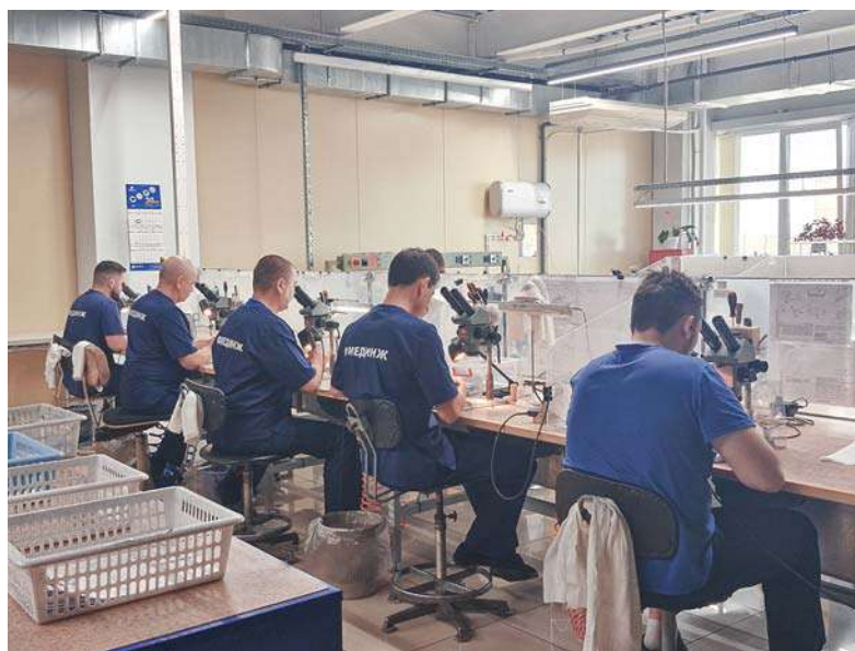
Створки клапанов полируют под микроскопом
